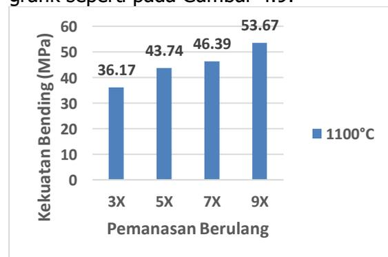
**Gambar 4.9.** Pengaruh pemanasan berulang terhadap kekuatan bending komposit clay/fly ash komposisi 25 % fraksi berat fly ash dengan temperatur 1100 °C
